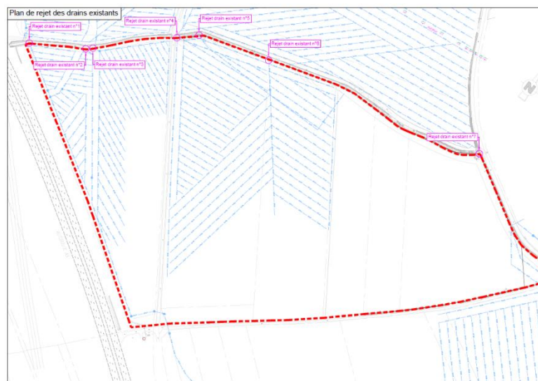
Figure 17 : Plan des drains existants et les points de rejet dans le ru d'Andy (Source : Bérin)
