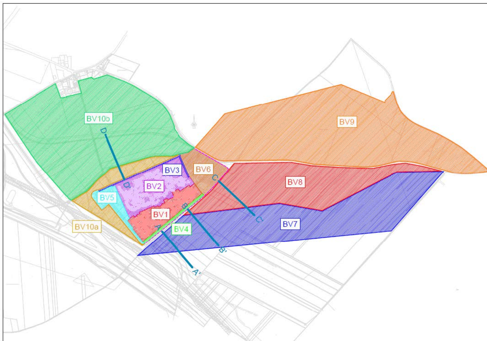
Figure 42 : Schéma des bassins versants avec la localisation des coupes AA', BB' et CC' (Source : Bérin)
