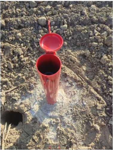
Figure 67 : PHOTOS DE LA PARTIE AERIENE DES PIEZOMETRES (Source : SAGA INGENIERIE)
