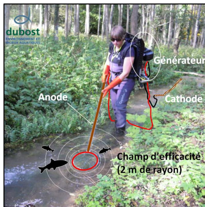
Figure 16 - Illustration du principe de pêche à l'électricité avec un appareil portable (Dubost Environnement)
